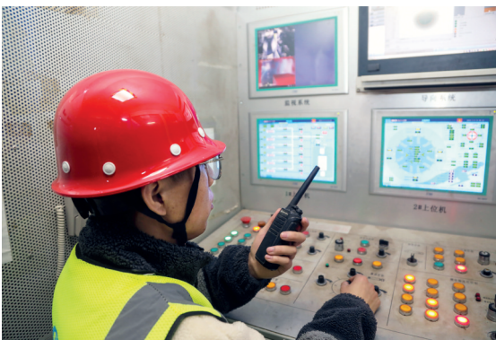
▲掘进参数实时监控
