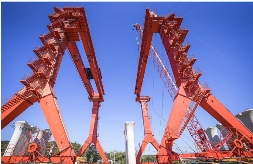
11月2日,中铁四局八分公司负责的巢(湖)马(鞍山)城际铁路马鞍山南制梁场两台TLJ550提梁机组装完成。此次拼装的提梁机为新制TLJ550提梁机,采用两台提梁机抬吊一片箱梁的形式,在两台同步工作下可起吊重1100吨的箱梁。 吴怀球 赵梦婷 摄(影像四局)
