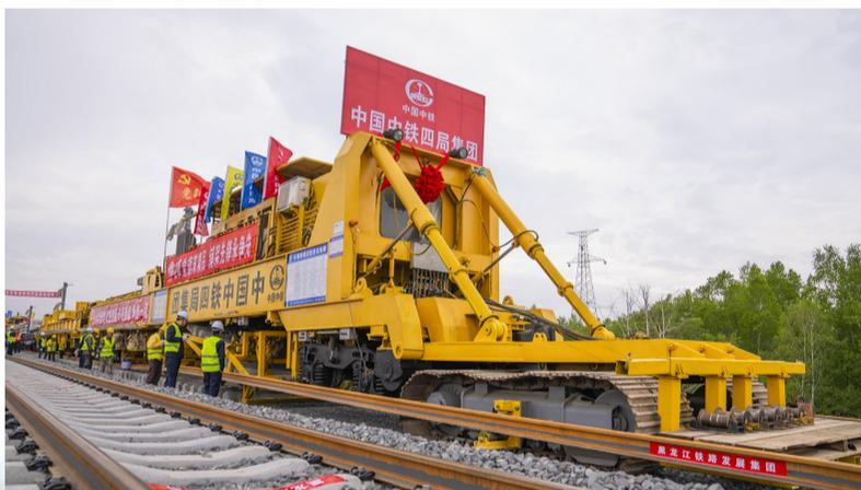
中铁四局自主研发的国内首台CPC500型无缝线路长轨余铺轨机组
