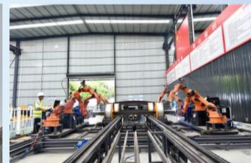
型钢拱架自动流水生产线
