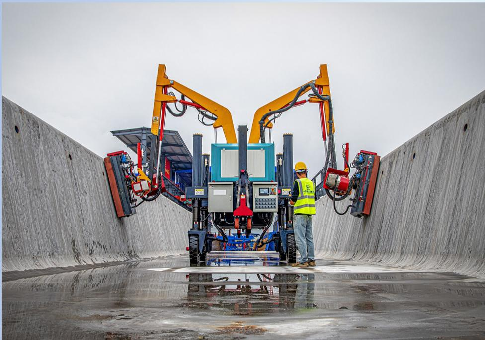
智能自行式模板打磨机进行箱梁模板打磨作业
