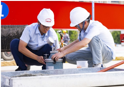
技术人员正在检测混凝土含气量
