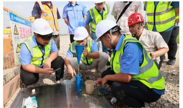
钻孔桩泥浆性能检测
