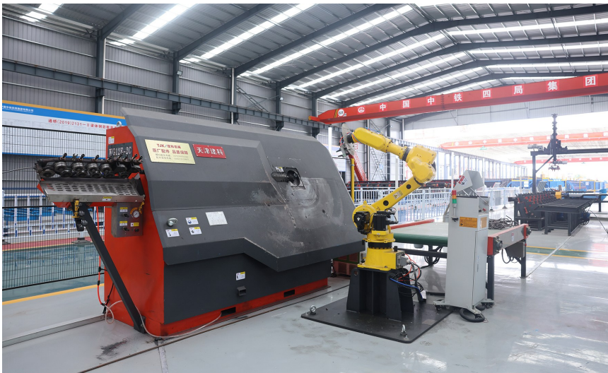
宝慧制梁场钢筋智能弯钩机
