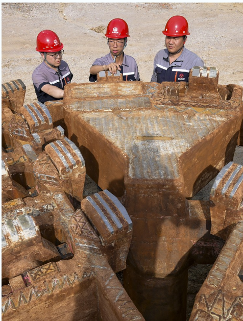
何源(中)与同事检修盾构刀盘刀具磨损情况
