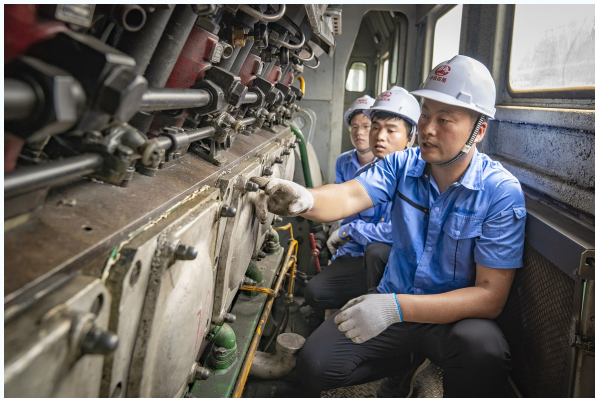
李维(前)正在讲解东风4B型柴油机检修流程
