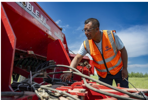
管理人员检查播种机液压线束,防止机械带病作业
