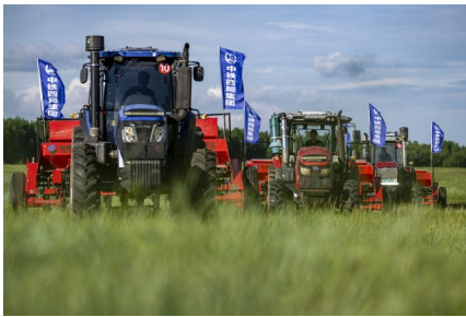
项目部采用牵引式草原免耕播种机施工作业
